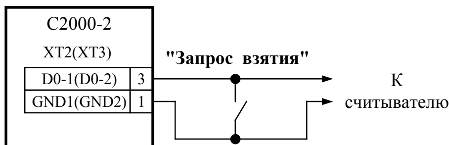
Рисунок 5 Подключение кнопки "Запрос взятия"
