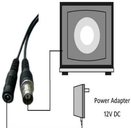
Рис. 6.1.1. Коммутация разъемов видеокамеры
